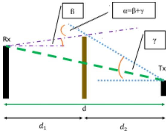
Fig.3. Single Knife Edge Diffraction Model
